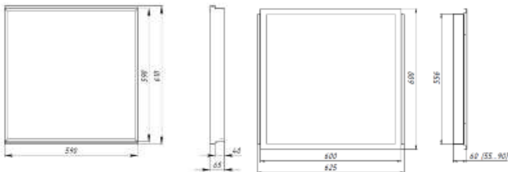
Рисунок 2 — Габаритные размеры светильников серии Экофон.
